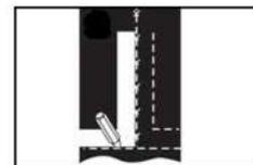
۲- زیر کار از یک تخته صاف استفاده کنید و سپس شابلون متناسب با سایز بست را با میخ به همراه نوار نقاله روی تخته چوبی ثابت کنید تسمه را بر اساس انحنای شابلون ببرید.
