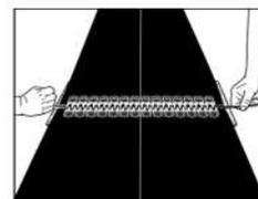
۹- مطابق شکل لبه های پشتی تسمه را در دوسمت تسمه با زاویه ۴۵ درجه برش دهید.
