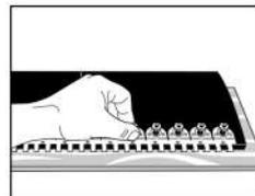
۶- با استفاده از آچار مخصوص فلکسکو و با استفاده از یک دریل ضربه ای پیچ ها را در جای خود محکم کنید.
