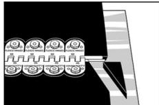
۱۰- واشر مخصوص را جهت فیکس شدن پین لولایی در انتهای پین قرار داده و با انبر سفت کنید.
