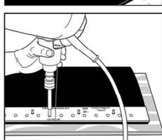
۴- برای تسمه ها با لایه بالایی بیشتر از ۴.۸ میلیمتر، لایه برداری با لایه بردار مخصوص فلکسکو پیشنهاد می شود.
