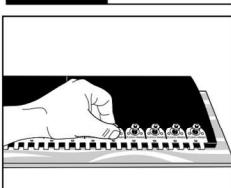
۶- با استفاده از آچار مخصوص فلکسکو و با استفاده از یک دریل ضربه ای پیچ ها را در جای خود محکم کنید.
