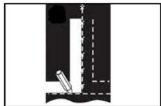
۲- زیر کار از یک تخته صاف استفاده کنید و سپس شابلون مناسب با سایز بست را با میخ به همراه نوار نقاله روی تخته چوبی ثابت کنید تسمه را بر اساس انحنای شابلون ببرید.
