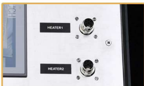
کانکشن کابل اتصال اتوها روی باکس برقی
